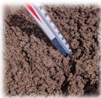
Figure 7 : mesure de température l'aide d'un thermomètre à mercure (Boussalia et Saoudi, 2023).
